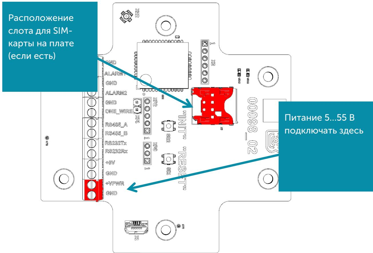
Модем NB-13 работает только от внешнего источника питания. В режиме «Сбор данных» после подключения к питанию 5...55 В устройство загружается и уходит в сон до выхода на связь по расписанию.
