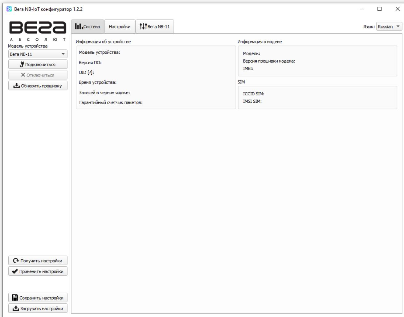
Меню слева позволяет выбирать модель устройства, осуществлять подключение к устройству или отключиться от него и обновить прошивку устройства.
